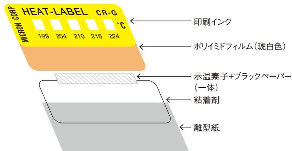
示温素子の融点を利用しています。規定温度に達すると溶けた示温素子が、下の黒い台紙にしみこむことでインジケータ窓部が黒くなります。ポリイミドカバーのタイプは、フィルム色の関係でインジケータが黄味がかって見えますが、実際は黒色に変色します。
